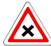
2.3.4 Пересечение равнозначных дорог
